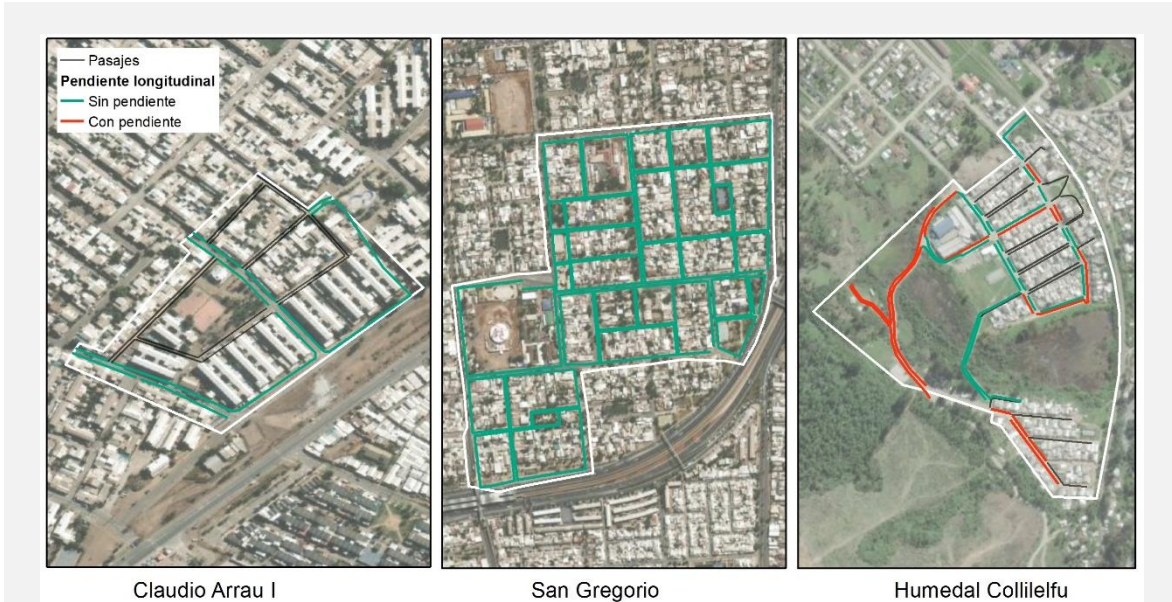
Figura 7. Pendiente longitudinal identificada por calle
