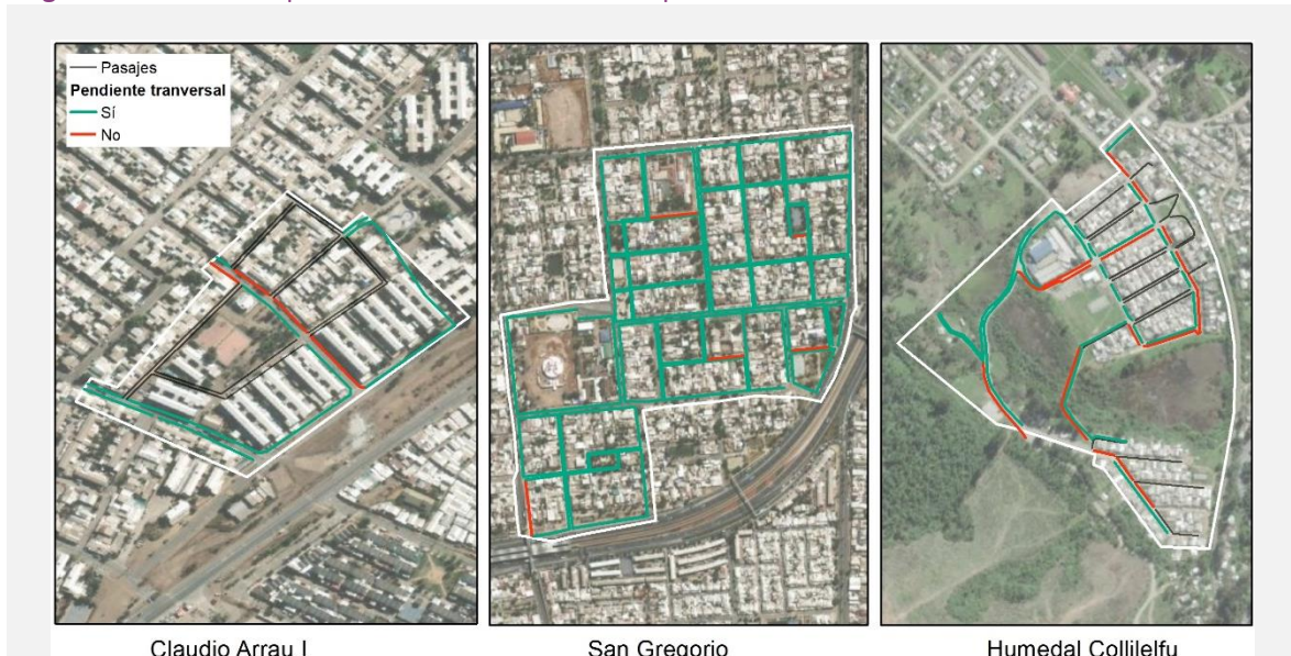
Figura 8. Veredas con pendiente transversal afectada por entradas de estacionamientos
